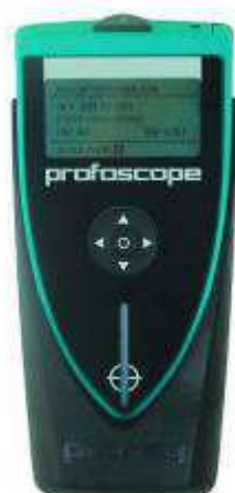
Fig. 3 Strumento utilizzato per le indagini (pacometro modello “Profoscope Proceq”).
