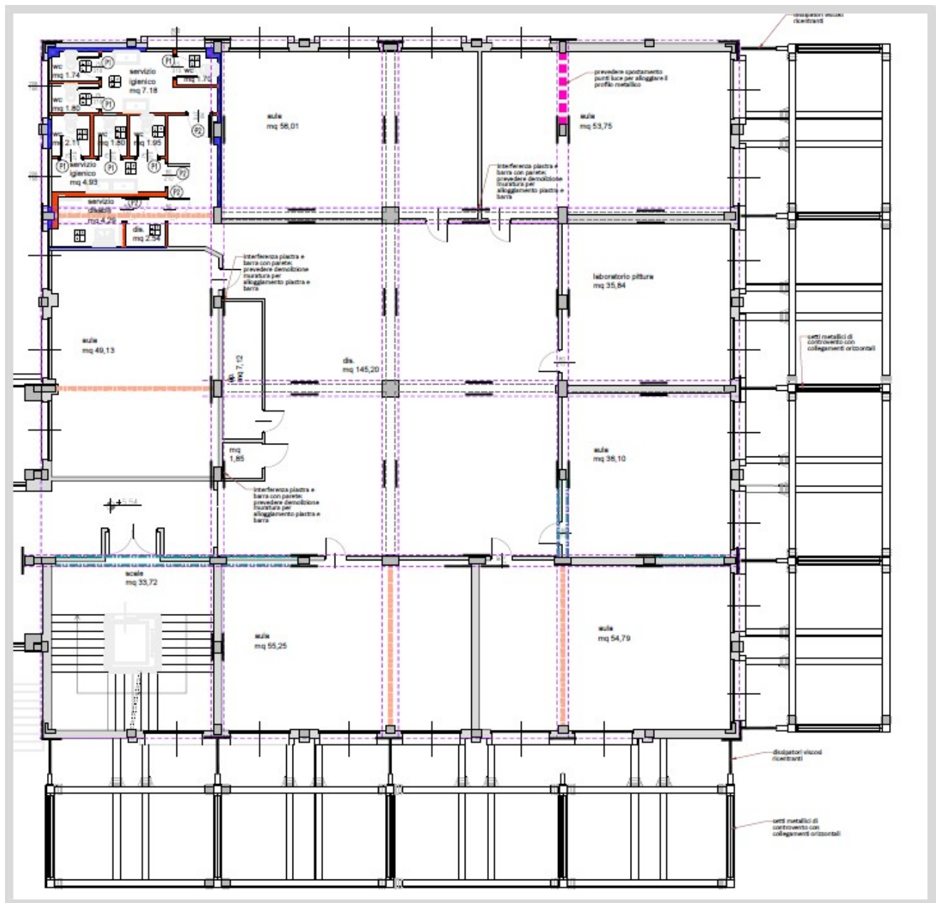
Figura 10: Sistema di tiranti in corrispondenza del secondo solaio del corpo est
