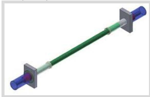
Figura 30: Esempio di barra dywidag
